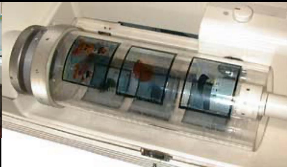
・ポジフィルムをデータ化し、印刷などに対応する精度のデータを得るためするには高性能のドラム型スキャナでのスキャンングが必要。
